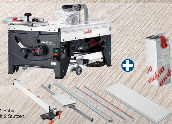
**\*Lieferumfang:** 1 Sägeblatt-HM, 250x1,8/2,8x30 mm, Z40, WZ, 1 Anbausatz Räder, 1 Schiebestock, 1 Multifunktionsanschlag MFA, 1 Sechskantschlüssel 6 mm, 1 Absaugset mit 2 Stutzen, 1 Klemmstück, 1 /Quickstand/, 1 Anschlussleitung 4 m
