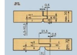
⑤ 04.3.132 Füge- und Abfasfräser für geschlossene Fuge Ø 129, B 9,6, ø<sup>1</sup>/ø<sup>2</sup> 50/30, Z 2
